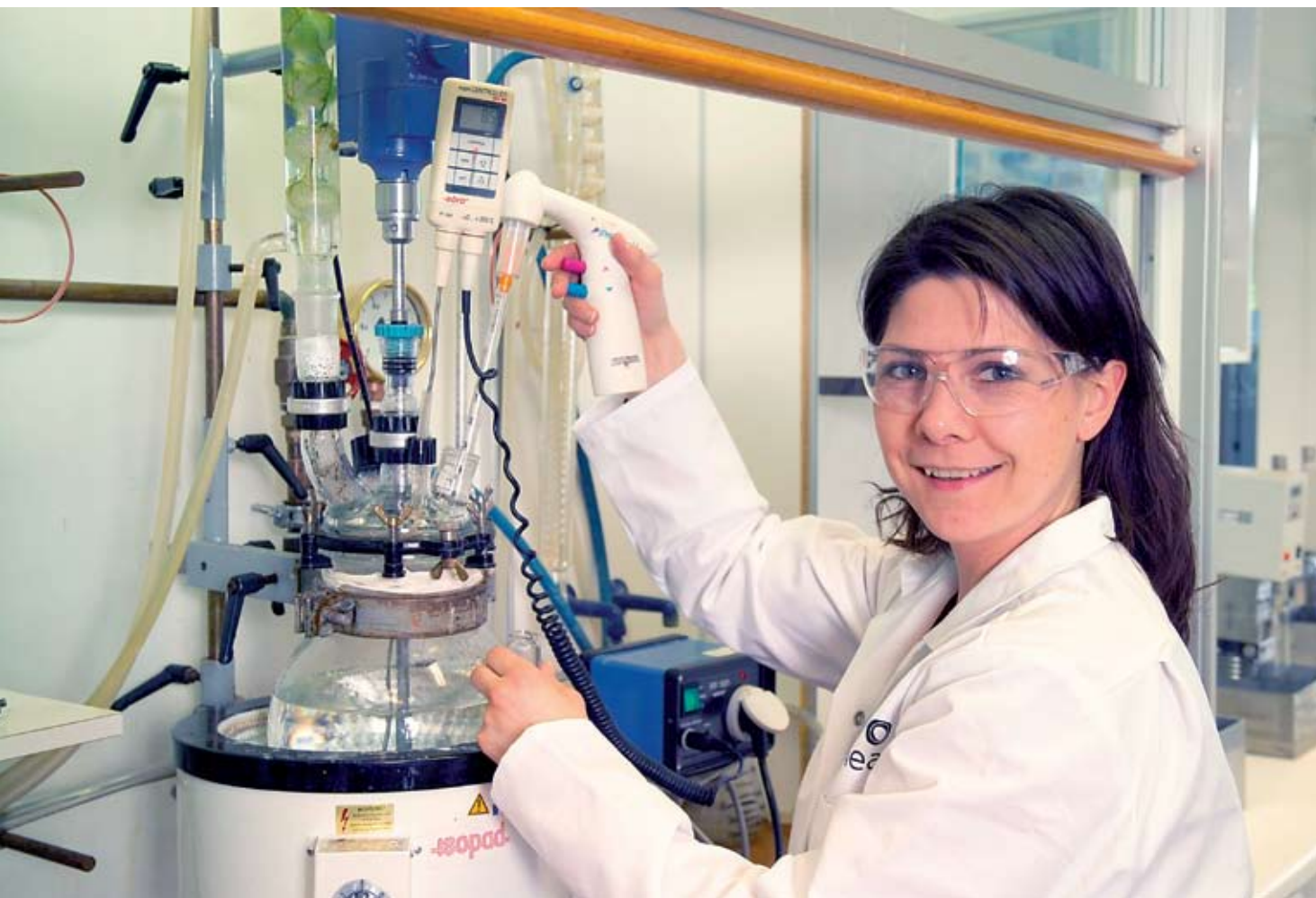
Dynean Norjan tutkimuskeskuksen laboratoriossa valmistetaan hartsia pienessä mittakaavassa lasisessa reaktoriastiassa.
