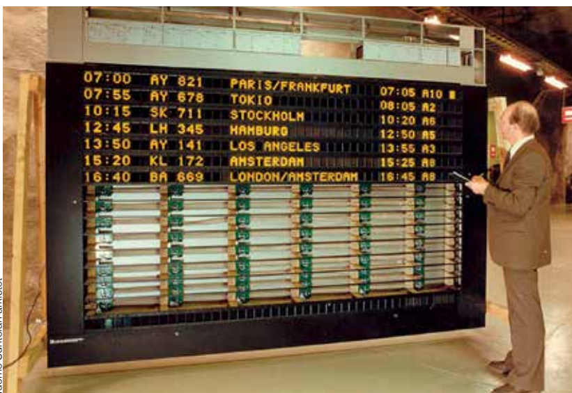
Tutkija Ralf Graeffe testaamassa ALD-pinnoitettua näyttöä Helsingin Vantaan lentoaseman maanalaisissa tiloissa vuonna 1983.
