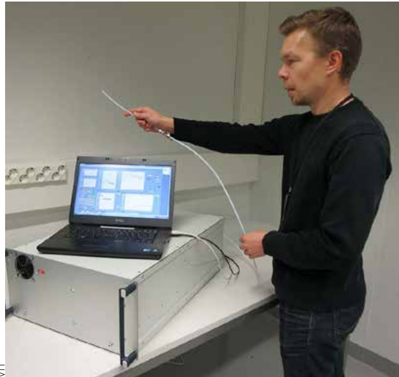
Tutkija Jussi Hämäläinen mittaa huoneilman ammoniakki- ja formaldehydipitoisuutta. Ilmaa imetään letkulla laitteen mittauskammioon, ja tulokset tulevat suoraan läppärin ruudulle.
